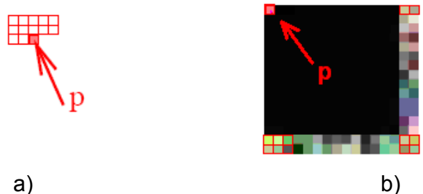
Slika 3.2.3.1 a) oblik kauzalnog susjedstva, b) oblik nekauzalnog susjedstva rubnog elementa
