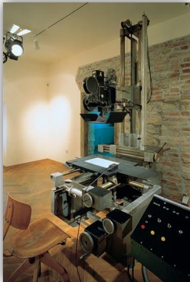
Slika 5.4. Kamera za snimanje crteža na celuloidnoj foliji
