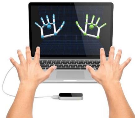
*Slika 2-3 Leap Motion u kombinaciji s desktop računalom*
