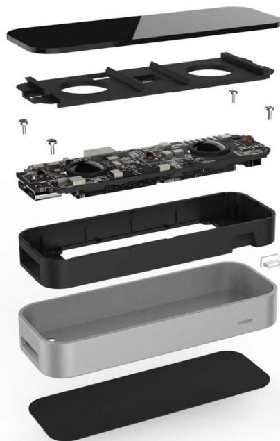
Slika 2-2 Dijelovi Leap Motion kontrolera
