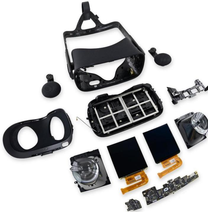
Slika 4 – Sastavni dijelovi uređaja Oculus Rift [2]
