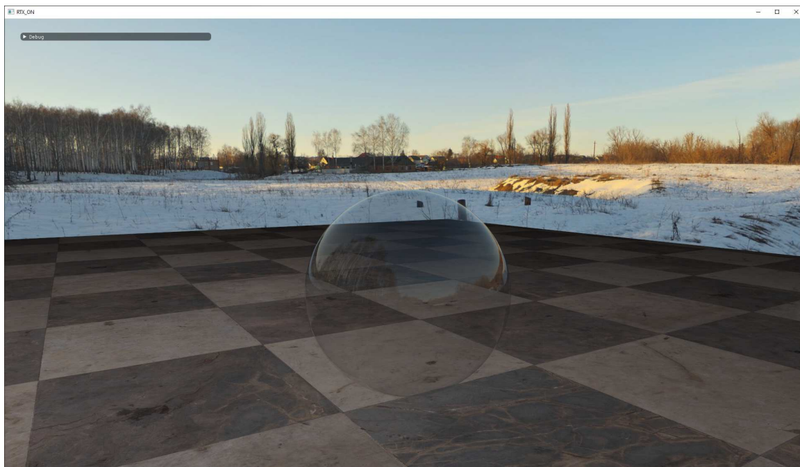
Slika 4.3: Refleksija i refrakcija na staklenoj sferi uz Fresnelov koeficijent
