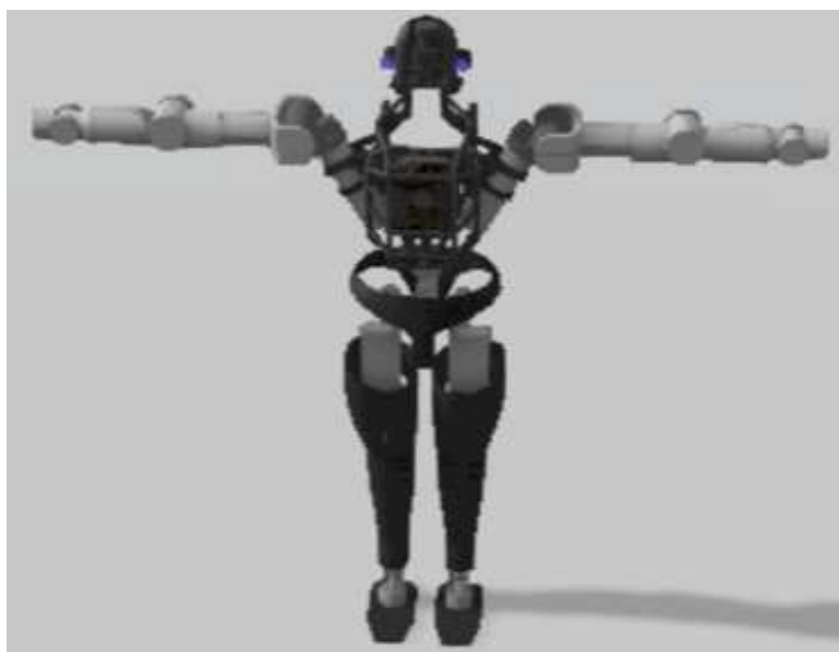
Slika 2.4: 3D model robota Atlas u programskog paektu Webots
