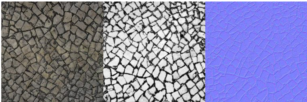
Slika 15. (s lijevo na desno) Tekstura, dubinska karakteristika, mapa normala
