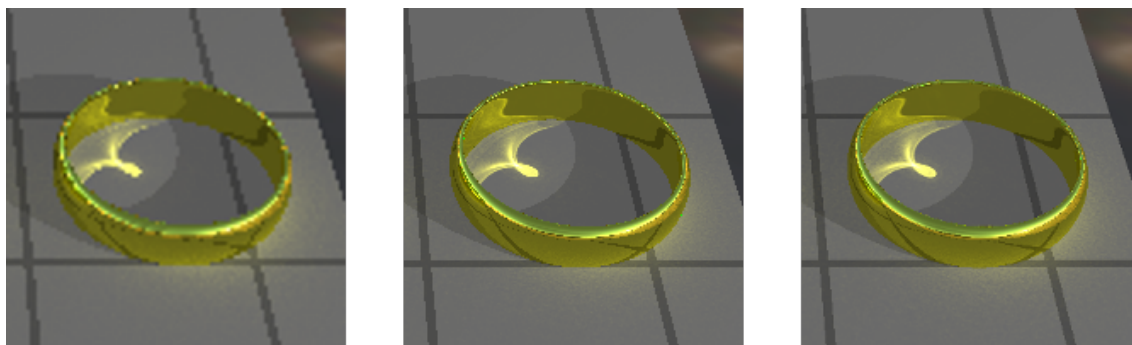
Slika 3.10: Rezultat dobiven praćenjem fotona i korištenjem tehnologija OptiX i CUDA. Lijeva slika – 256x256; srednja – 512x512; desna slika – 1024x1024
