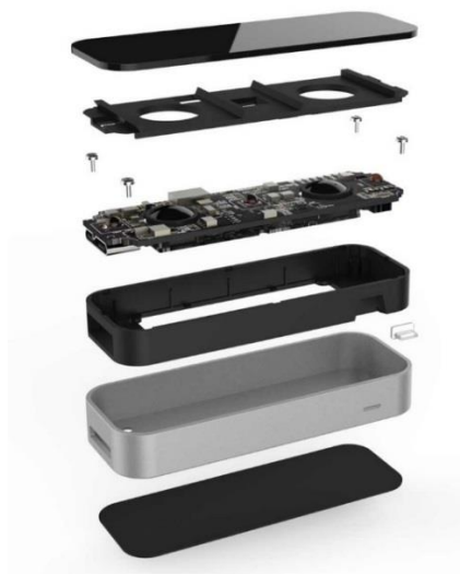
Slika 2. Sklopovlje uređaja Leap Motion [11]
