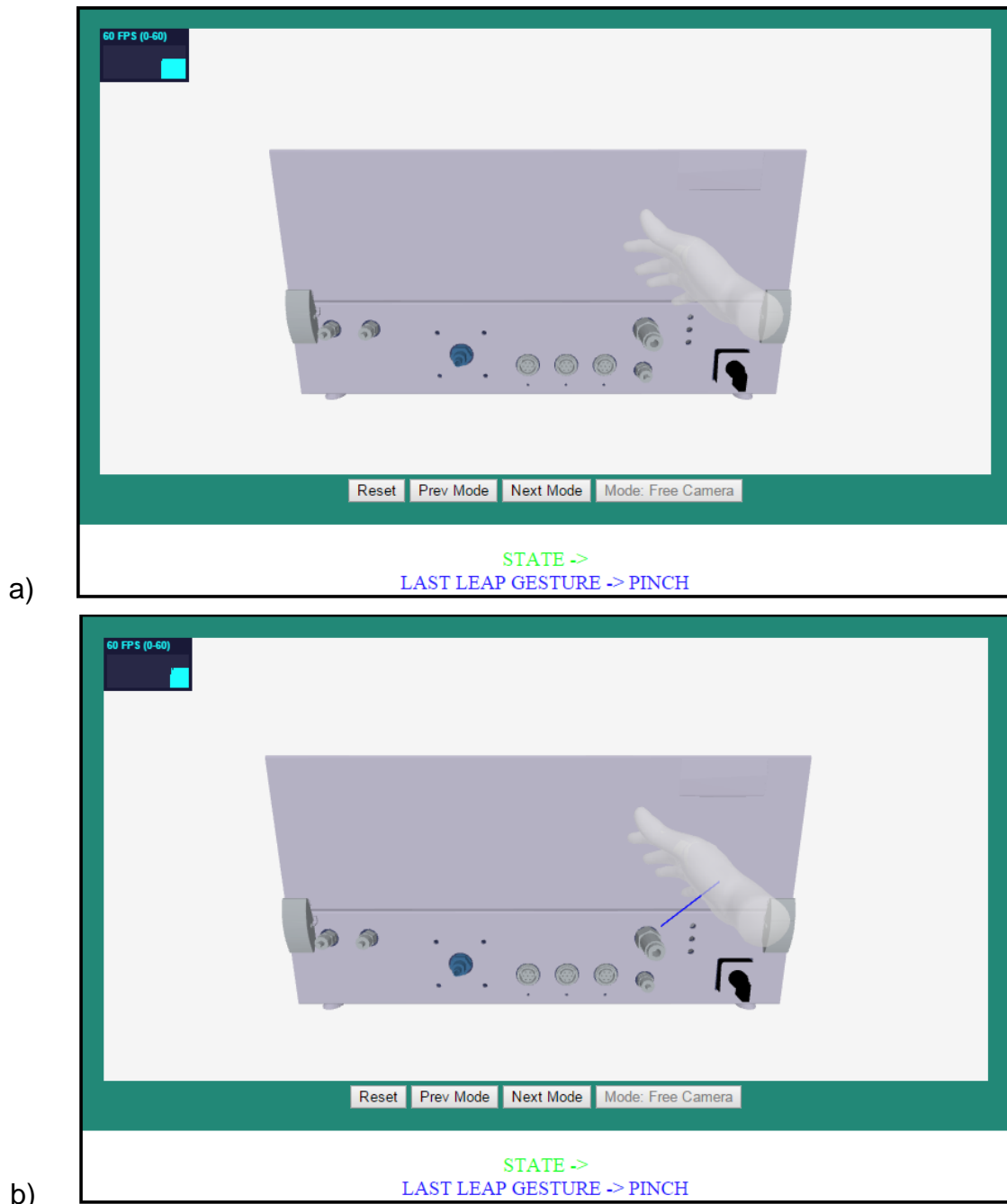
Slika 20. a) model ruke bez normale, b) model ruke s nacrtanom normalom
