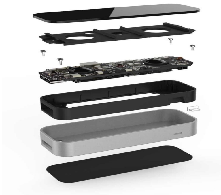
Slika 2 Slojevi sklopovske opreme Leap Motiona
