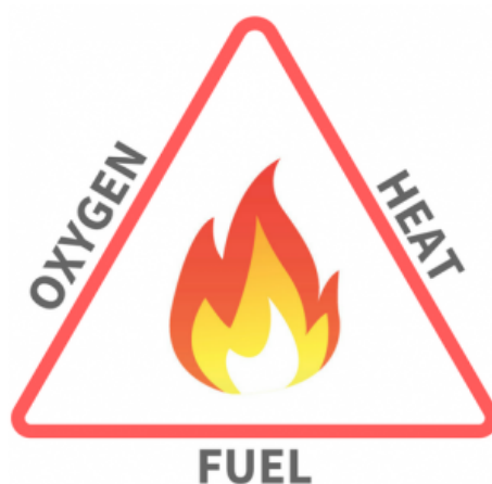
Slika 3.1: Tri neophodna elementa za proces izgaranja požara
