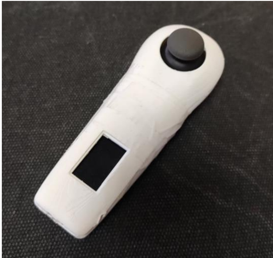
Slika 1 Kontroler za virtualnu stvarnost
