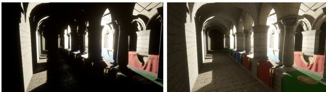
Slika 3.3.1: Prikaz virtualnog okruženja iscrtan samo direktnim osvjetljenjem (lijevo) i kombinacijom direktnog i indirektnog osvjetljenja (desno)
