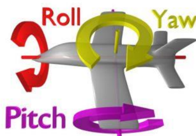
Slika 2. Nagib dubina i smjer u koordinatnom sustavu objekta.
