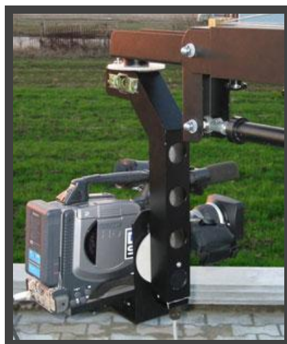
Slika 3.4.2. Robotska glava za kameru izbliza.
