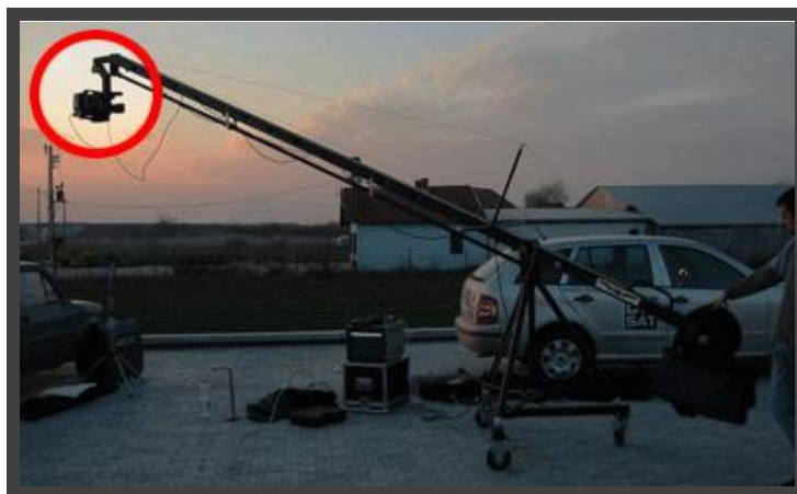
Slika 3.4.1. Robotska glava pričvršćena na vrh ruke dizalice.
