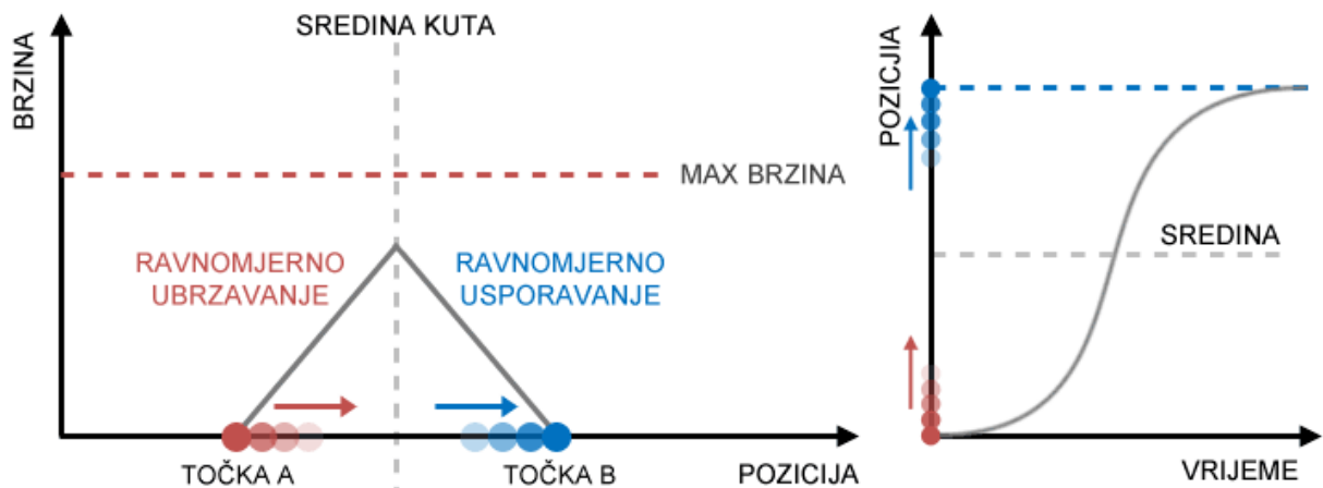
Slika 7.4.4. Graf brzine i pozicije glave pri glatkom prijelazu sa jedne točke ciljanja na drugu.
