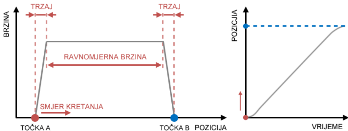
Slika 7.4.3. Graf brzine i pozicije glave pri prijelazu ciljanja sa točke A na točku B realiziran jednostavnom linearnom interpolacijom između početnih kutova.
