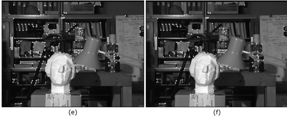
Slika 6.6: Ovisnost broja značajki detektiranih SUSAN detektorom uglova o pragu t . Prikana je ulazna slika (a), te ulazna slika s označenim uglovima detektiranim SUSAN detektorom uglova za vrijednosti parametra t=10 (b), t=20 (c), t=30 (d), t=40 (e), t=50 (f).
