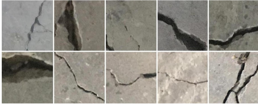
Sl. 2.2 Primjerci iz dijela skupa podataka s oštećenjima koji predstavljaju stršeće vrijednosti
