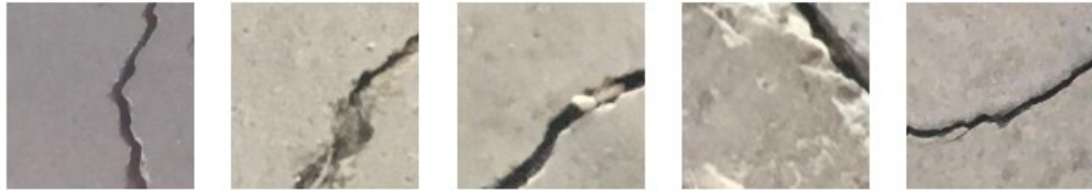
Sl. 2.14 Stršeće vrijednosti koje algoritam VAE ne detektira (FN)
