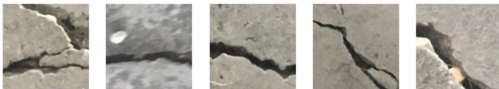
Sl. 2.4 Stršeće vrijednosti koje algoritam IF ne detektira (FN)
