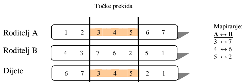
Slika 3.9. – Prikaz PMX metode križanja za kromosome koji su predstavljeni kao nizovi cijelih brojeva
