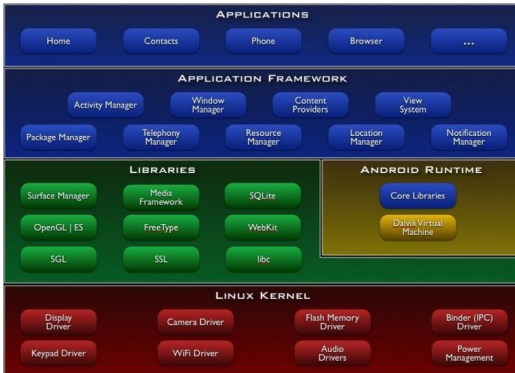
Slika 2.1. Arhitektura Android operacijskog sustava
