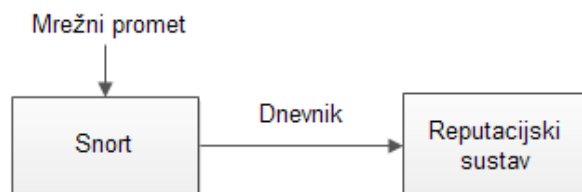
Slika 4.1: Sustav za mjerenje neželjenog prometa
