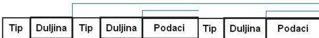
Slika 2.6 Format BER kodiranog polja (složeni tip podataka)
