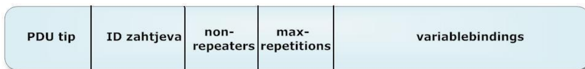
Slika 2.15 SNMP PDU za operaciju većinskog dohvata
