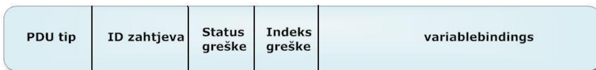
Slika 2.12 SNMP PDU za GetResponse
