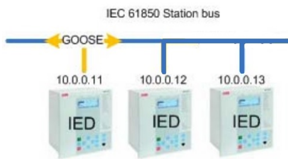
Slika 3.2: Komunikacija između IED uređaja putem GOOSE protokola 4
