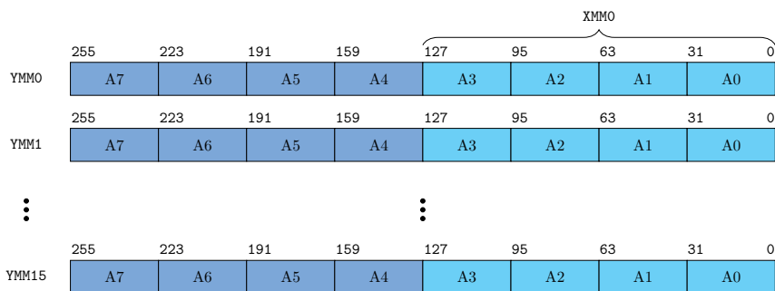
Slika 6: Registri instrukcijskog skupa AVX : AVX instrukcijski skup koristi 16 256-bitnih registara koji su ostvareni kao proširenja registara XMM. Time je i broj XMM registara povećan na 16.
