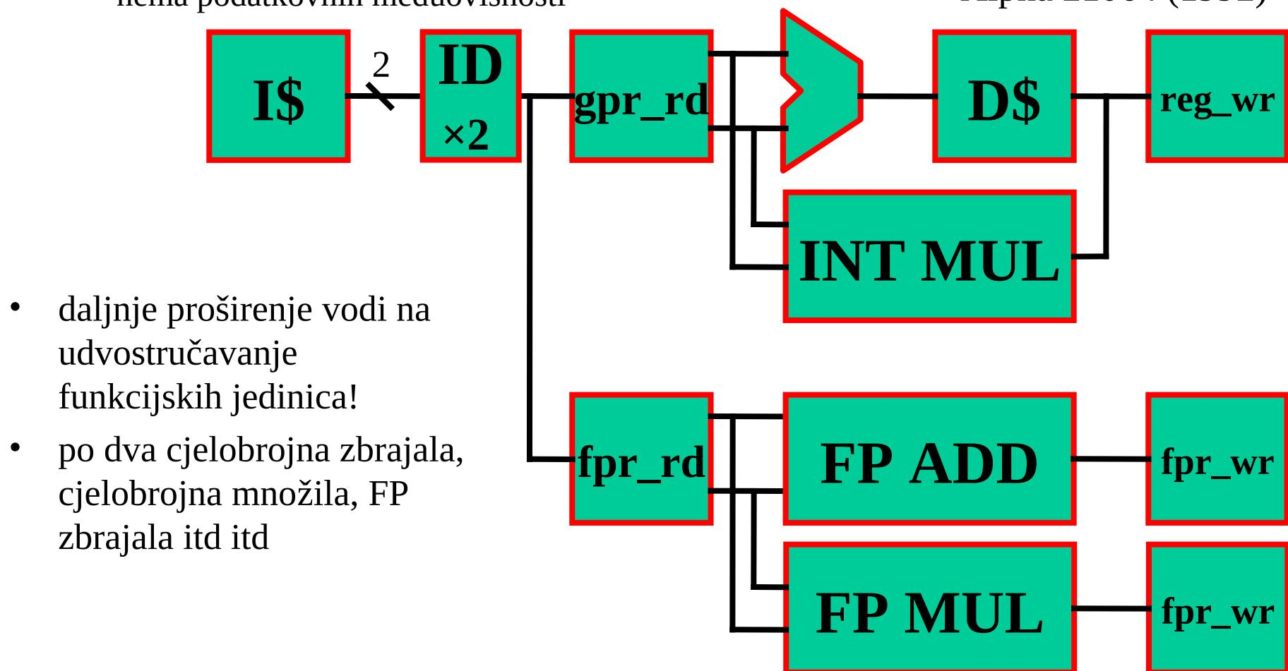
**Ideja:** istovremenim **izdavanjem** više instrukcija razotkriti više instrukcijskog paralelizma nego što to omogućava protočnost
