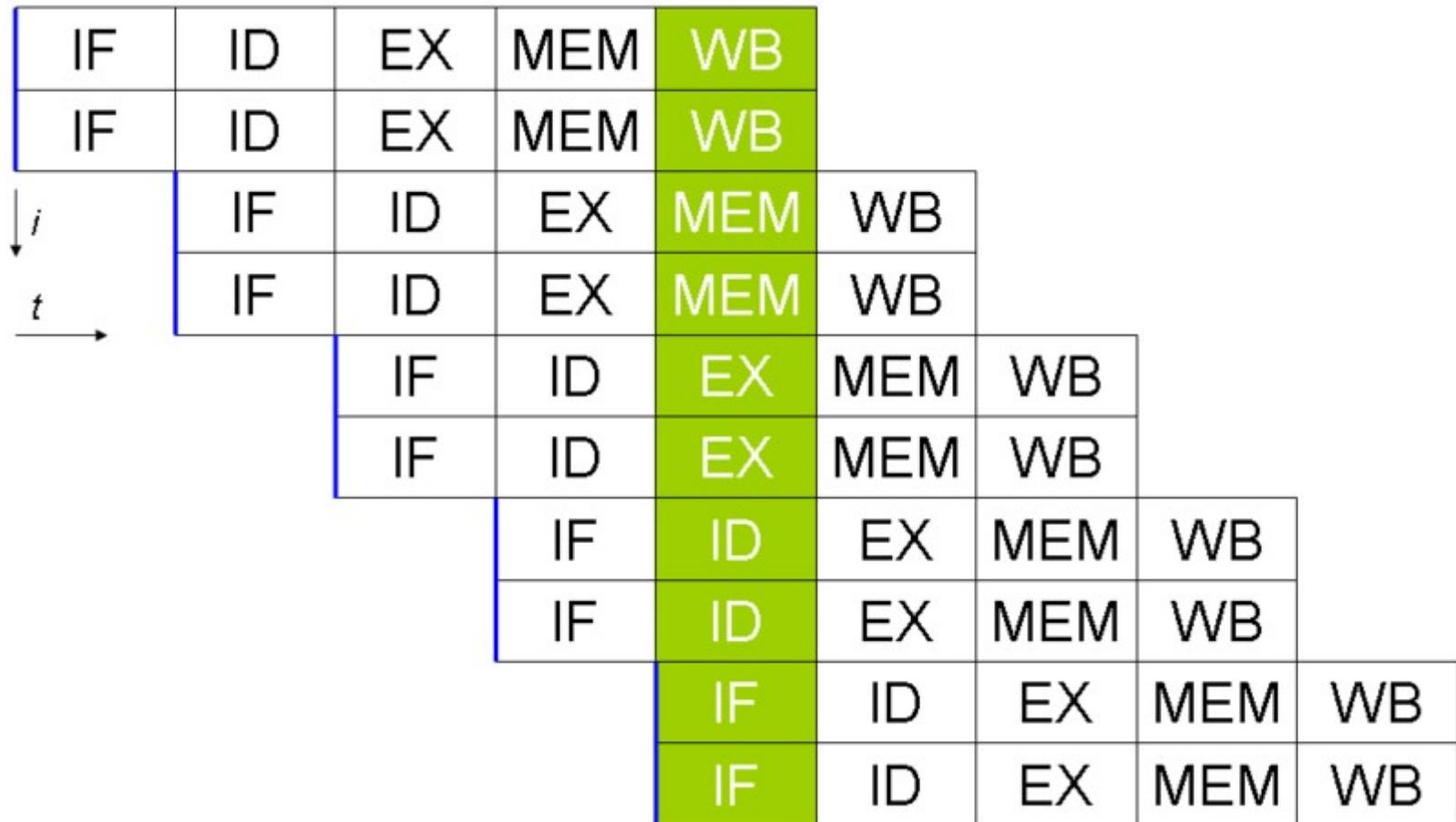
Dva načina raspoređivanja (engl. dispatch) kod procesora s višestrukim izdavanjem:
