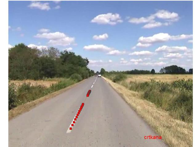
Prije samog postupka prepoznavanja, ulazna slika pribavljena iz perspektive vozača transformira se u tzv. rektificiranu sliku koja bi se dobila iz ptice perspektive. Ovakvim prikazom postiže se konstantna širina razdjelnih linija, kao i njihova međusobna paralelnost, što pojednostavljuje postupke pronalaženja i raspoznavanja.
