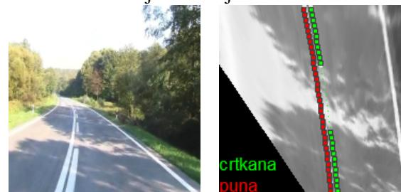
Nakon uspješne detekcije razdjelne linije, praćenje i prikaz moguć je i na originalnom videu ponovnim korištenjem perspektivne transformacije.
