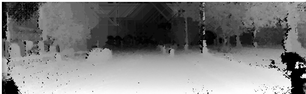
Slika 2.10: Mapa dispariteta izgrađena algoritmom poluglobalnog podudaranja
