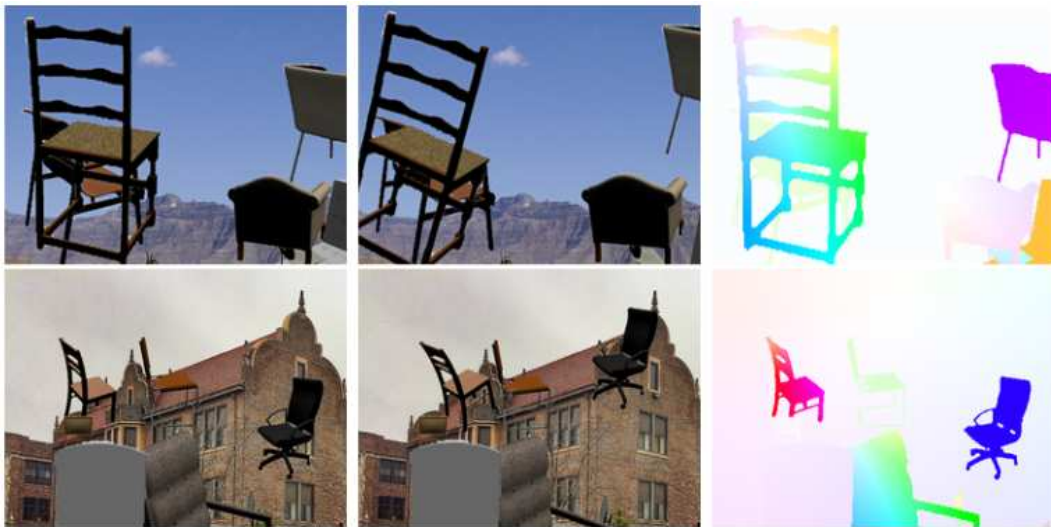
Slika 5.1: Primjer dva podatka iz Flying Chairs skupa podataka. Prve dvije slike predstavljaju ulaze, a zadnje slika optički tok označen na prvoj slici. Izvor: Fischer et al. (2015)
