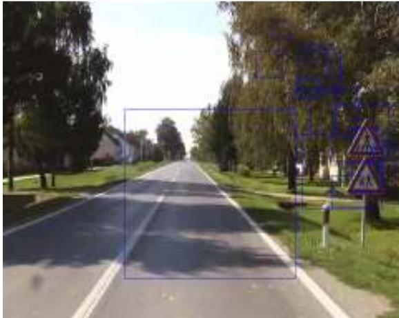
Slika 15. Primjer lažno-pozitivnih detekcija dobivenih korištenjem heterogene kaskade (hetero1) bez dodatnih razina.
