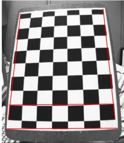
Slika 2.3: Primjer distorzije slike na šahovskoj ploči koja se najčešće koristi za geometrijsku kalibraciju kamere. Ravne i paralelne linije u stvarnosti ispadnu zaobljene na slici. Izvor: [35]
