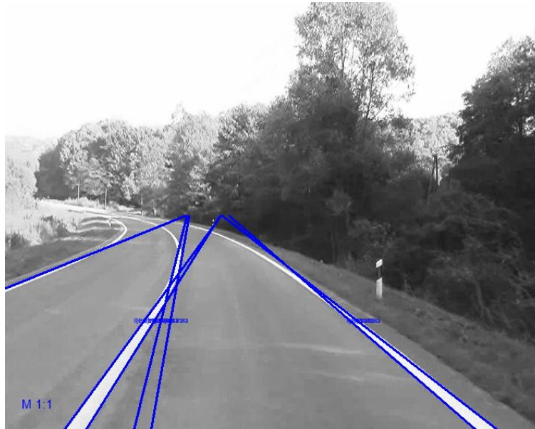
Slika 20: pronalazak neželjenih segmenata nakon postavljanja parametra consideredImagePart na 0.5
