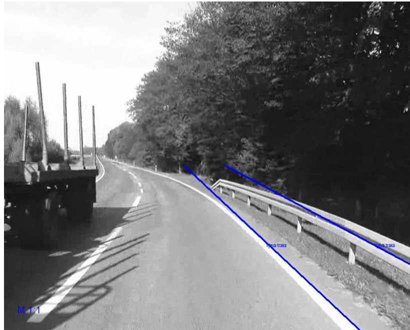
Slika 22: propuštena detekcija lijeve linije traka zbog sjene vozila iz susjednog traka
