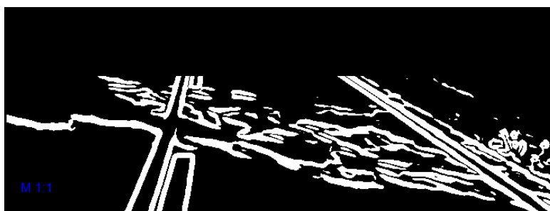
Slika 15: slika amplituda gradijenata piksela sa slike 14
