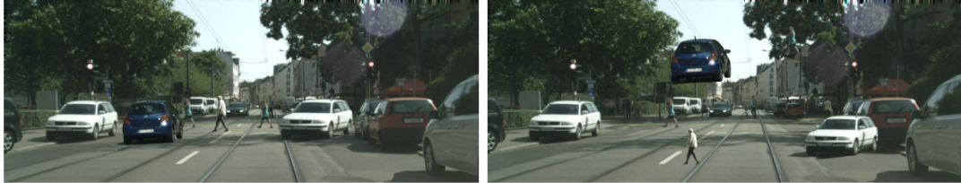
Slika 6.1: Usporedba lijepljenja objekata na horizontalnoj liniji u odnosu na originalnu poziciju (slika lijevo) i na nasumično odabranim pozicijama (slika desno) [22].
