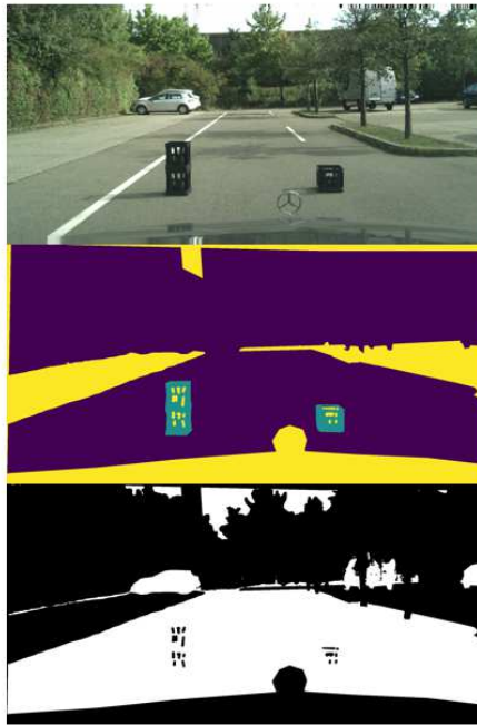
Slika 8.3: Na slici dan je rezultat zadatka detekcije anomalija na primjerku slike iz skupa FS Lost&Found. Koristili smo model Mask2Former koji se učio samo na skupu Cityscapes. Redom je prikazana ulazna slika, njezina oznaka i detekcija anomalija gdje bijeli pikseli označuju anomalije.
