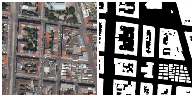
Slika 3.1: Primjer satelitske snimke dijela grada Beča i njezine maske. Bijeli pikseli u masci znače da se na tom mjestu u originalnoj slici nalazi zgrada. Izvor: [10]
