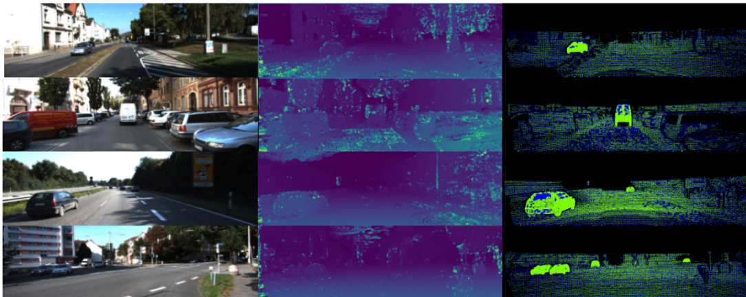
Slika 6.4: Prikaz rekonstrukcijske točnosti modela za ugrađivanje okana u visokodimenzionalan prostor. Lijeve slike prikazuju slike iz lijeve referentne kamere. U sredini se nalaze procijenjene mape dispariteta. Na mapi dispariteta što je svjetliji piksel to je veći disparitet, a tamniji što je manji. Zdesna se nalaze rekonstrukcijske točnosti, pri čemu su crnom bojom označeni pikseli uz nepoznat disparitet, plavom bojom pogrešno rekonstruirani pikseli, te zelenom bojom točno rekonstruirani pikseli.
