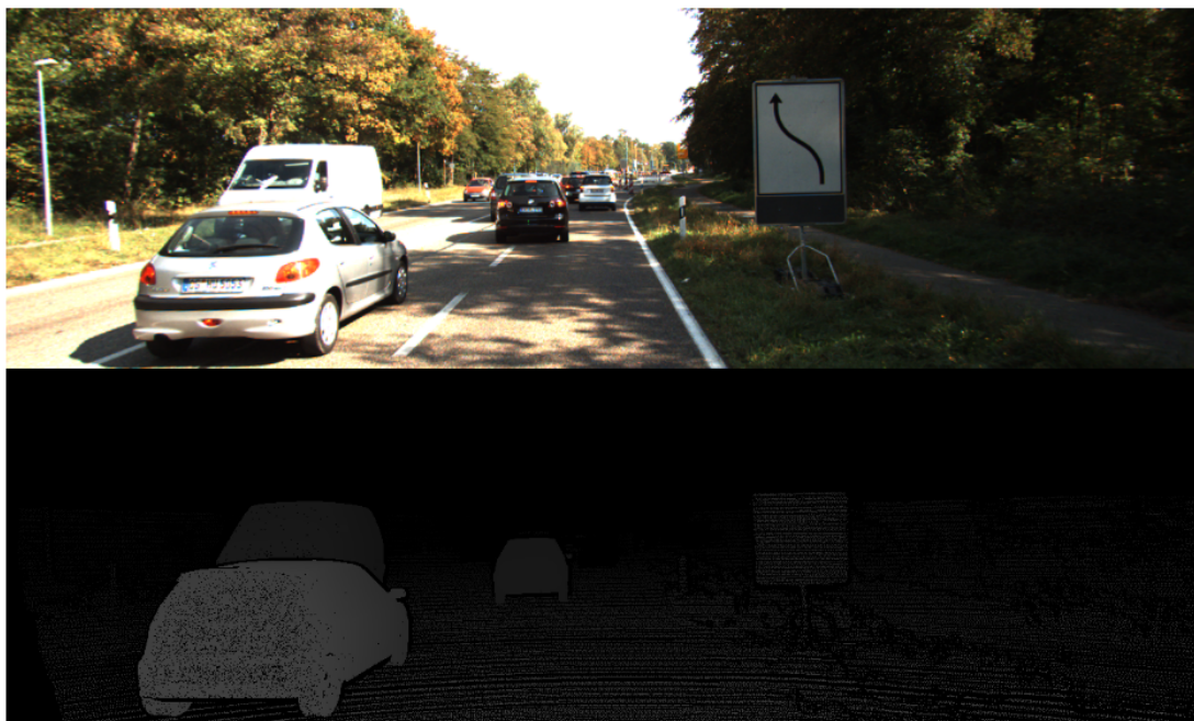
Slika 4.1: Primjer iz podatkovnog skupa KITTI 2015. Gornja slika prikazuje referentnu lijevu sliku, a donja slika prikazuje odgovarajuću mapu dispariteta dobivenu laserskim senzorom.
