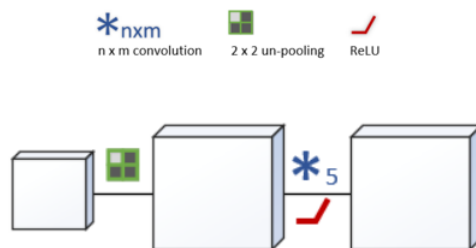
Slika 4.5: Up-convolution blok. Ulaz u blok se prvo puni nulama, čime se dimenzije duplo povećavaju, zatim se primjenjuje konvolucija pa ReLU. Ovakvi blokovi mogu naučiti naduzorkovanje, za razliku od bilinearnog naduzorkovanja koje je fiksno određeno. Više ovakvih blokova poredanih uzastopno mogu naučiti nelinearno naduzorkovati.
