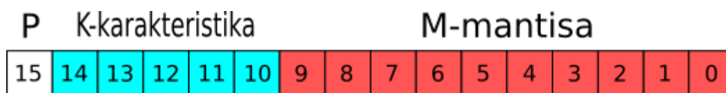
Slika 3.1: FP16 prikaz brojeva s posmičnim zarezom. P predstavlja bit predznaka.
