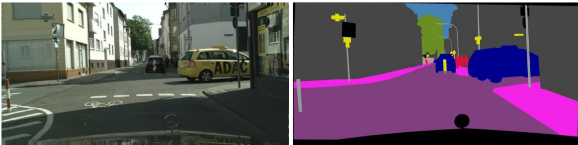
Slika 54 Slika (lijevo) i GT segmentacijske oznake slike (desno).
