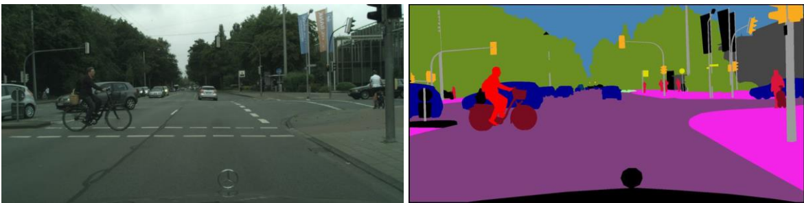
Slika 66 Slika (lijevo) i GT segmentacijske oznake slike (desno).
