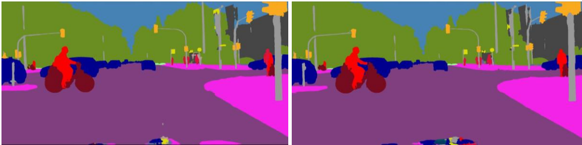
Slika 69 Segmentacijska mapa modela SwiftNet-RN18-ss (lijevo) i SwiftNet-RN18-pyr (desno).
