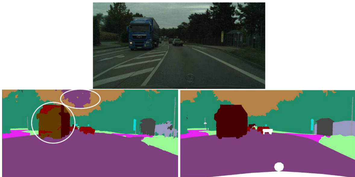
Slika 5.3: Primjer lošijeg zaključivanja modela BPNet-S3 na slici iz validacijskom skupa Cityscapesa. Najizraženije greške označene su bijelim elipsama. Jedna od grešaka je da model kamion sa slike djelomično označava kao automobil, djelomično kao autobus, a djelomično ga točno označava kao kamion. Druga očita greška je da je dio neba označen kao cesta. Ulazna slika – gore; označen izlaz – dolje lijevo; točne oznake – dolje desno.
