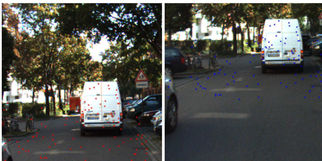
Slika 6.3: Par slika KITTI 2015 s korespondencijskim točkama koji dobijemo primjenom 2.pristupa
