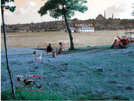
Slika 5.4: Primjer rada Mask R-CNN detektora na jednoj slici. Detektor je za svaki objekt na slici predvidio koordinate njegovog okvira i razred u koji taj objekt pripada.
