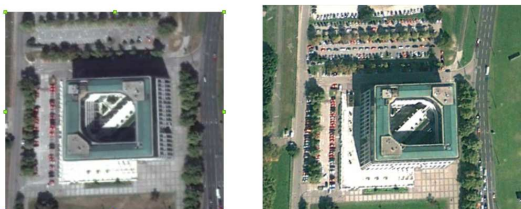
Slika 3.11: Različiti kutevi snimanja ( engl. off-nadir ). Sateliti najčešće ne snimaju površinu Zemlje koja se nalazi direktno ispod njih nego pod nekim kutem. Taj kut se u različitim prolazima nad istom lokacijom razlikuje jedan od drugoga.
