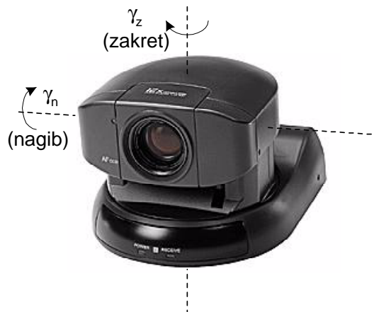
Slika 1.2: Stupnjevi slobode kamere.
