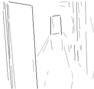
Slika 4.20: Rezultati obrade dnevnih slika hodnika. Obrada je trajala 16 (a), odnosno 14 iteracija (b). Tamnijim pravocrtnim segmentima pridružena je veća težina.
