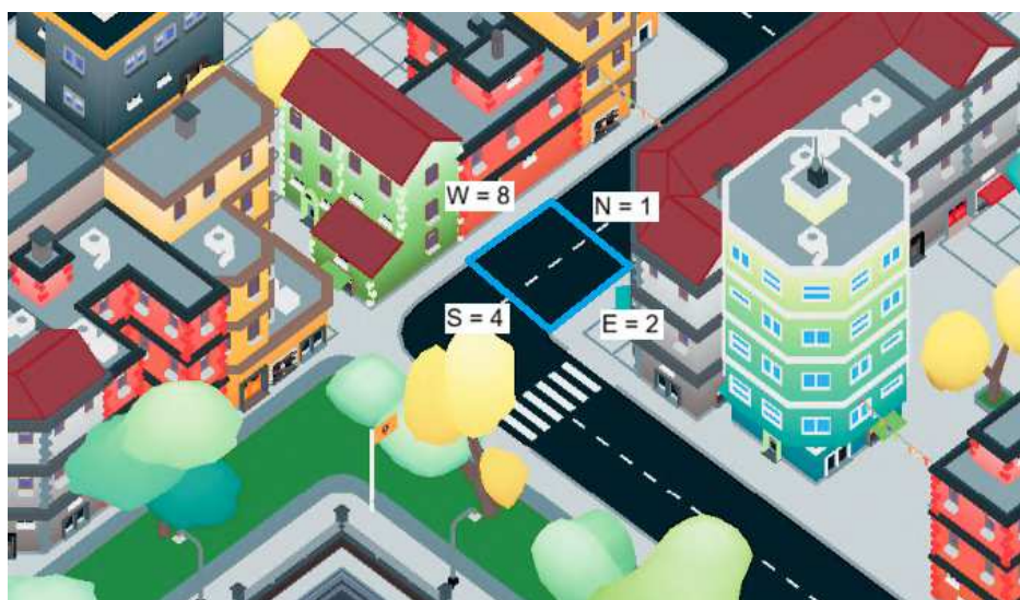
Slika 4.5. Prikaz sustava bitmaske u modelu grada
