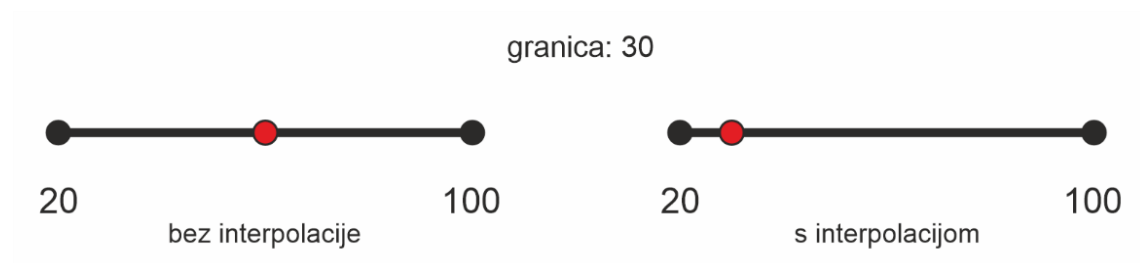
Slika 2.5 Vrh trokuta bez interpolacije i s interpolacijom
