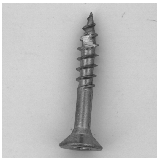
(b) Neispravan vijak
