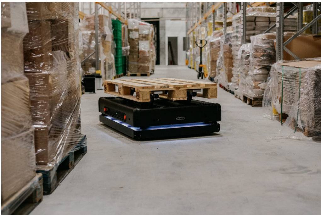
Slika 2.2: Robot s praznom paletom, koji može započeti izvršavati narudžbu. (Gideon Brothers, 2019b)
