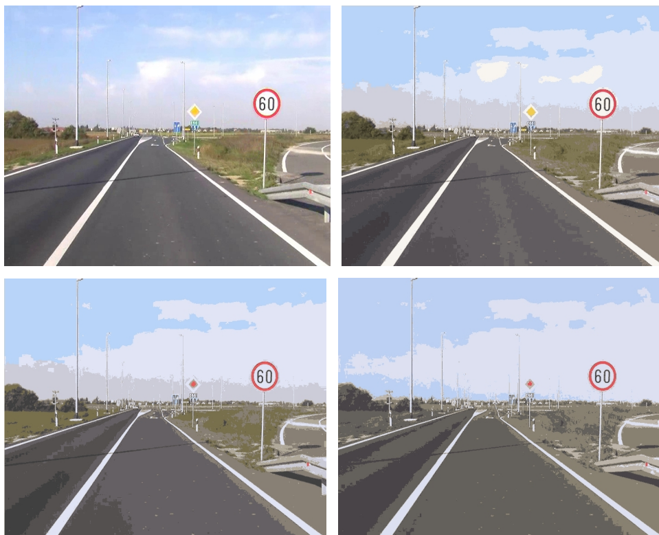
Slika 7: Segmentacija slike sa različitom vrijednostima praga (gore lijevo: original, gore desno: prag 200, dolje lijevo: prag 500, dolje desno: prag 1000)
