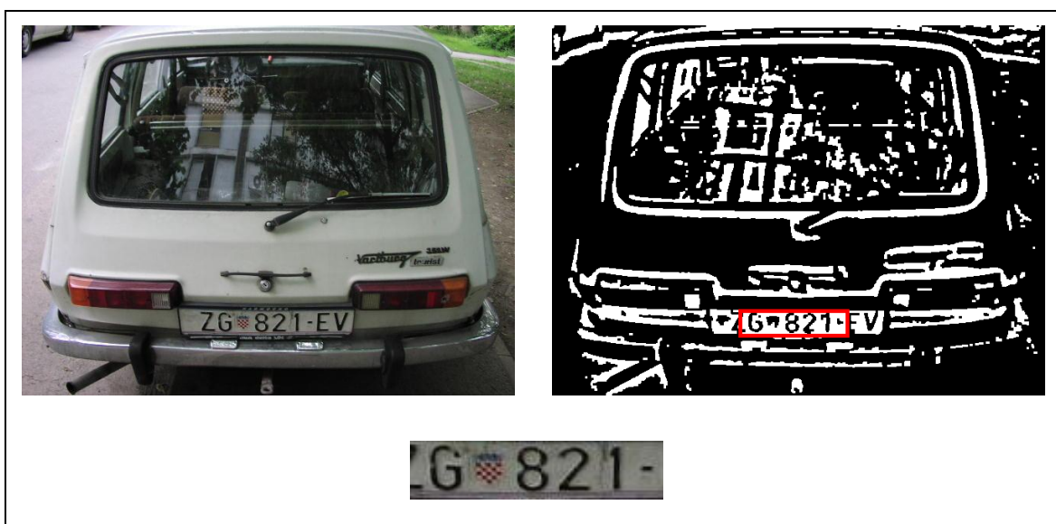
Slika 5.3 Djelomična detekcija tablice - segmentacija
