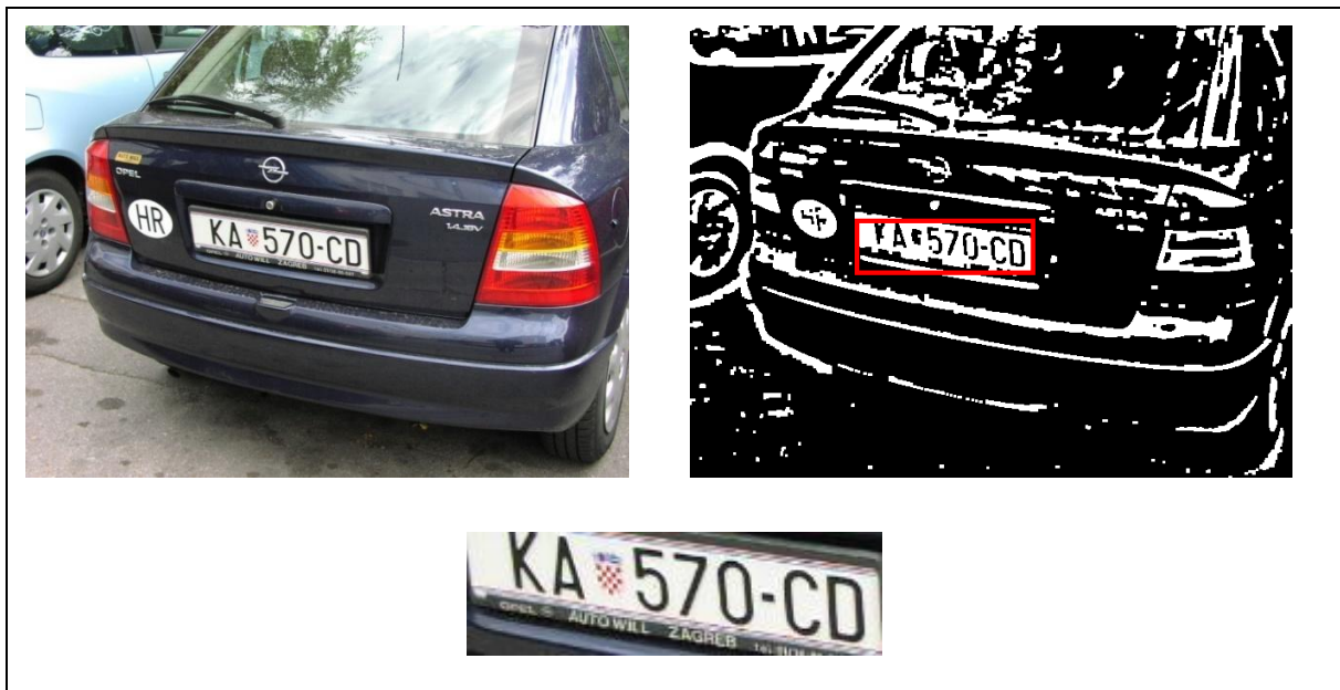
Slika 5.7 Detektirana nakošena tablica
