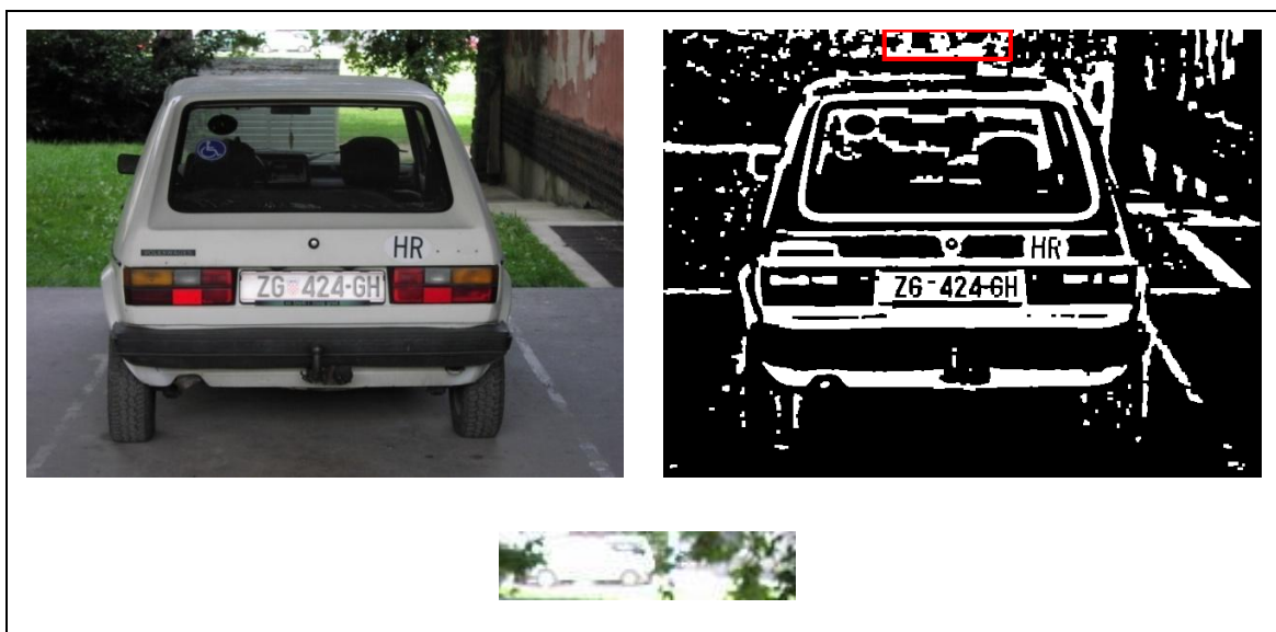
Slika 5.5 Djelomična detekcija bez točne tablice
