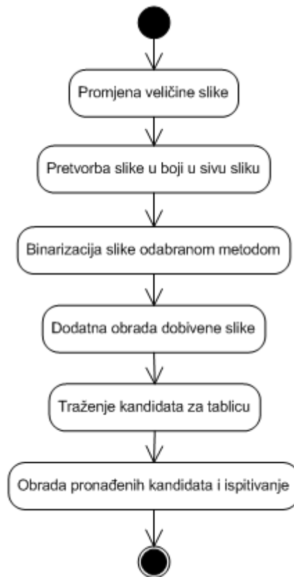
Slika 3.1 Dijagram stanja algoritma za detektiranje registarske tablice
