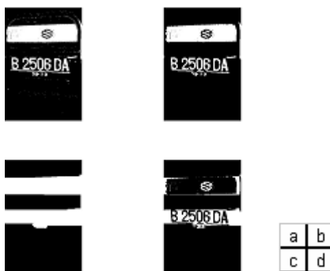
Slika 6.1 Morfologija a) originalna slika b) otvaranje c) zatvaranje d) rezultat ekstrakcije
