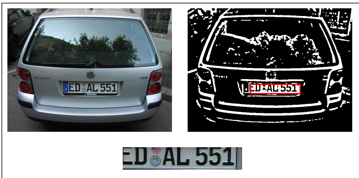
Slika 5.2 Djelomična detekcija tablice – oštećen rub
