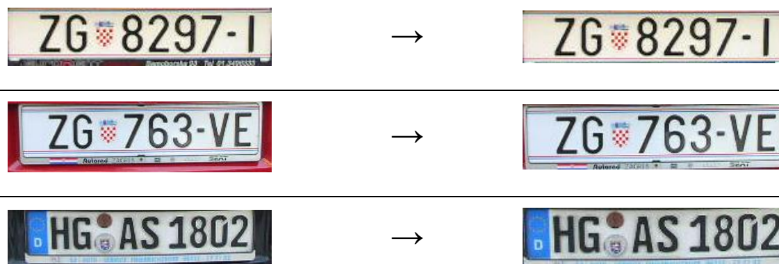
Slika 3.12 Obrada kandidata - uklanjanje dijelova koji nisu tablica
