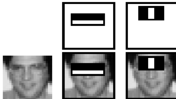
Slika 9. Prva i druga značajka klasifikatora koje je odabrao AdaBoost kod učenja na prepoznavanje lica. Značajke su prikazane u prvom redu, a u drugom redu su nacrtane preko tipične slike za testiranje. Prva značajka mjeri razliku u intenzitetu slike oko očiju i gornjeg dijela obraza. Značajka se iskazuje u tome da je najčešće područje oko očiju tamnije od gornjeg dijela obraza. Druga značajka uspoređuje intenzitet očiju i gornjeg dijela nosa.
