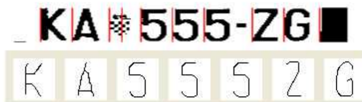
Slika 13. Segmentirana ploča i prepoznati znakovi nakon algoritma skeletonizacije
