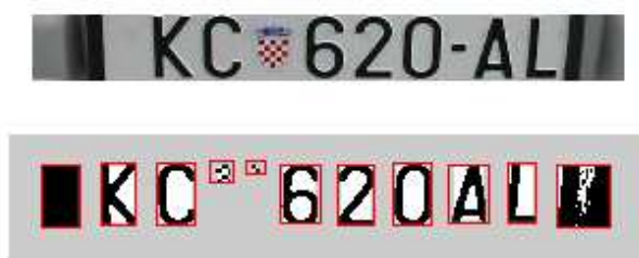
Slika 10. Tablica i detektirani segmenti. Svi lažni segmenti moraju biti odbačeni.
